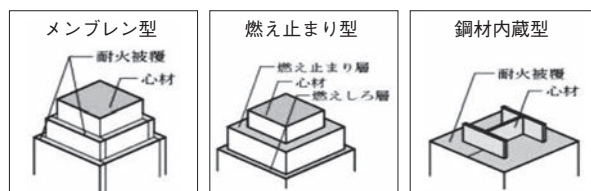
図3 木造耐火建築物の工法
