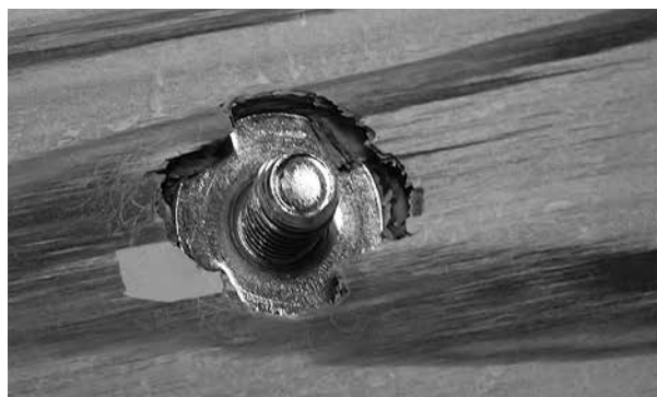
不燃木：M10、外径25mm／T型鬼目を締めすぎた場合
