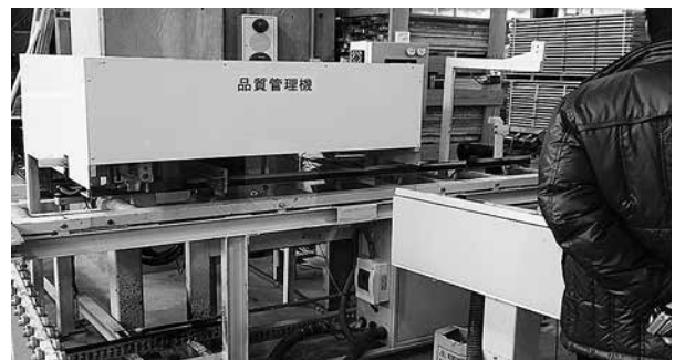
不燃性能検査：全数検査で含浸量を確認
