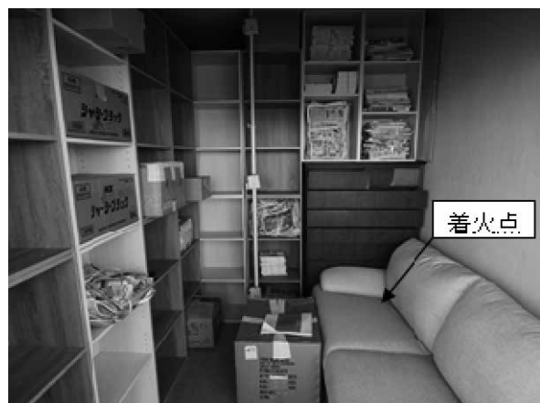
写真14 A室の可燃物配置状況 (掃き出し窓側から撮影)
