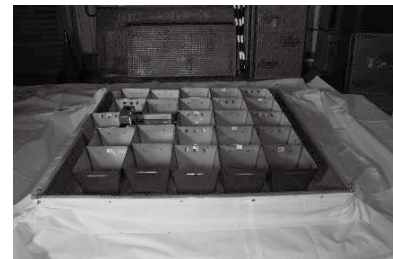
写真8 集水バケツの配置
