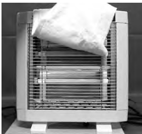
写真8 可燃物接触時の状況（安全装置作動時）
