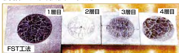
樹脂注入試験後の状況
