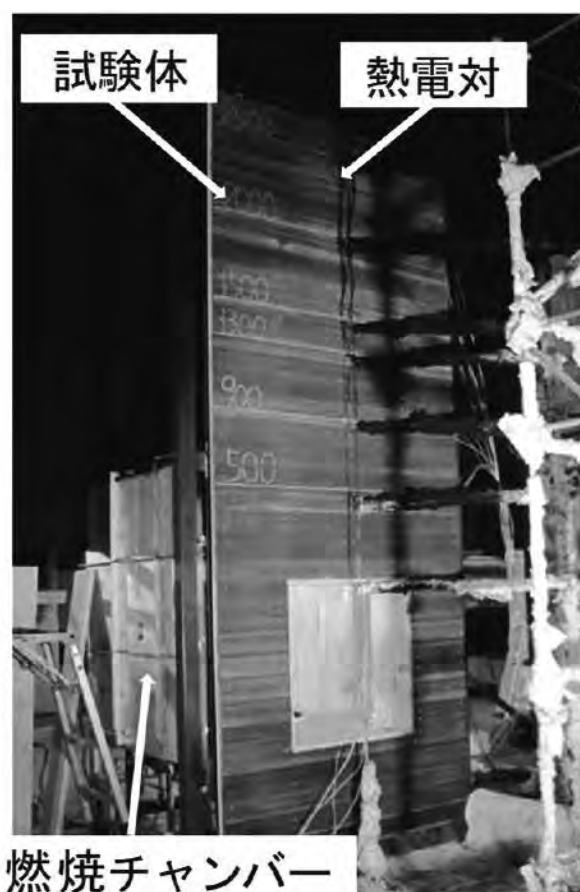
図6 装置概要 (JIS A 1310)
