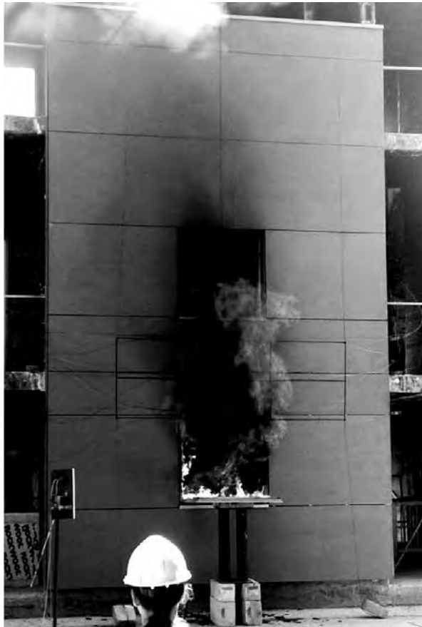
写真3 実大規模のファサード試験：MSZ 14800-6
