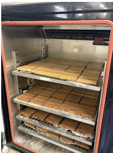
写真 48 恒温恒湿槽の様子
